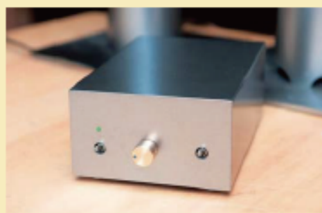
スイッチと音量ボリュームしかないシンプルなアンプ
