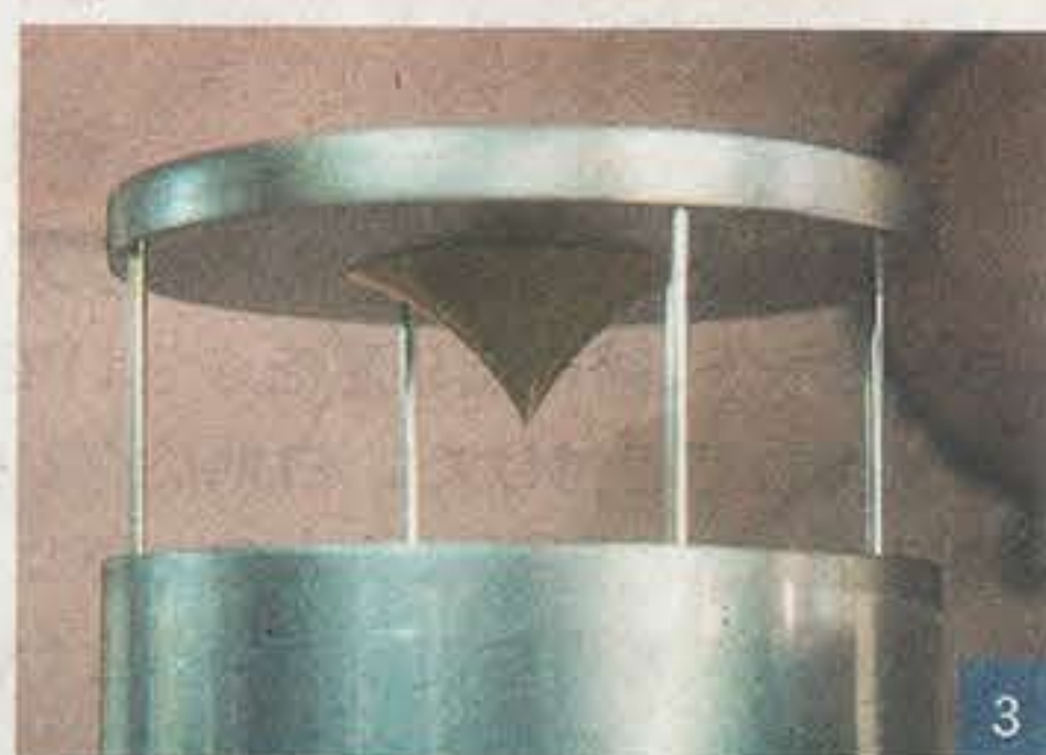
1 スピーカー2本+アンプで25万円~(税別) 2 和紙を用いた軽量のトリプルコーンで広帯域の自然な音を再現 3 上向きのスピーカーと円すい形の反射板で全方向に音が響く
