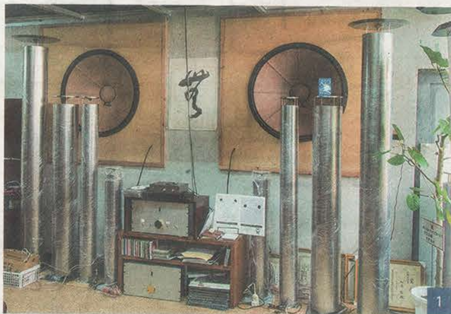
1 スピーカー2本+アンプで25万円~(税別) 2 和紙を用いた軽量のトリプルコーンで広帯域の自然な音を再現 3 上向きのスピーカーと円すい形の反射板で全方向に音が響く
